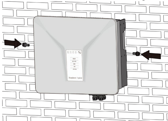
Abb. 12. Den Wechselrichter sichern
