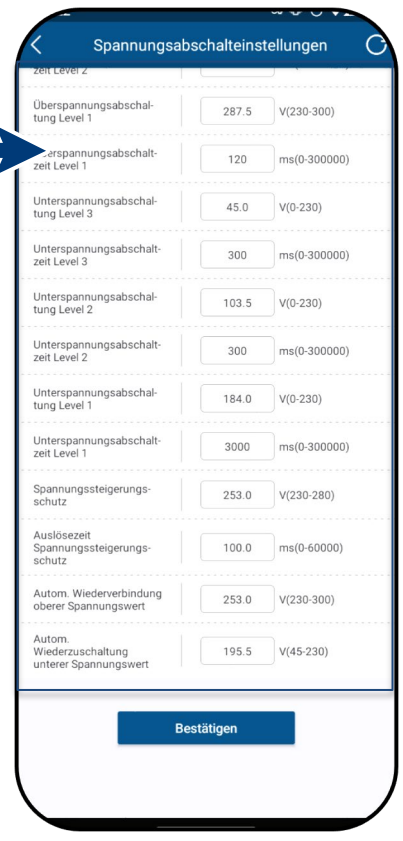
Abb. 137. Spannungsbereich und Abschaltzeiten festlegen
