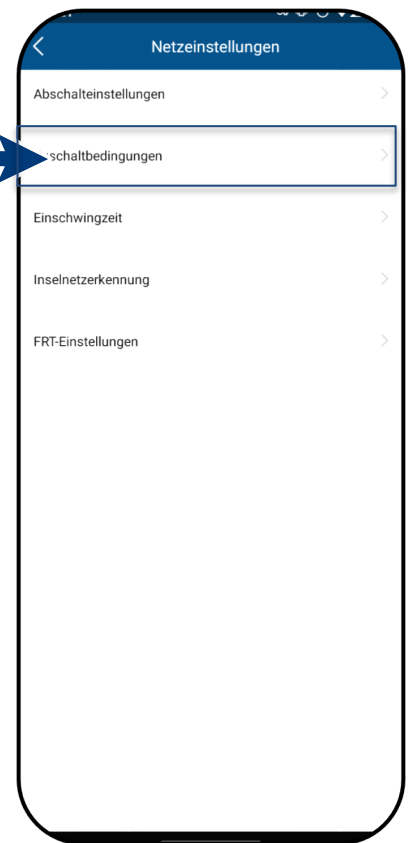
Abb. 143. Wählen Sie die Zuschaltbedingungen
