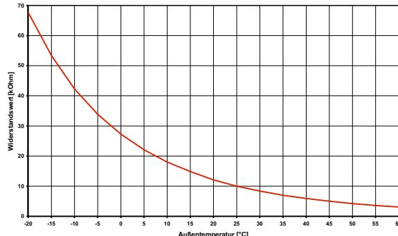
Abb. 7.1:Fühlerkennlinie NTC-10
