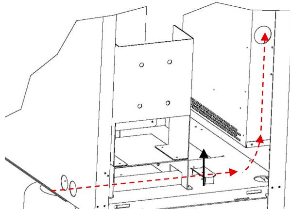
Fig. 7.3:Le câble de réseau doit être amené latéralement, à travers les tubes conducteurs, dans le boîtier de commande et doit être fixé dans la décharge de traction prévue à cet effet.
