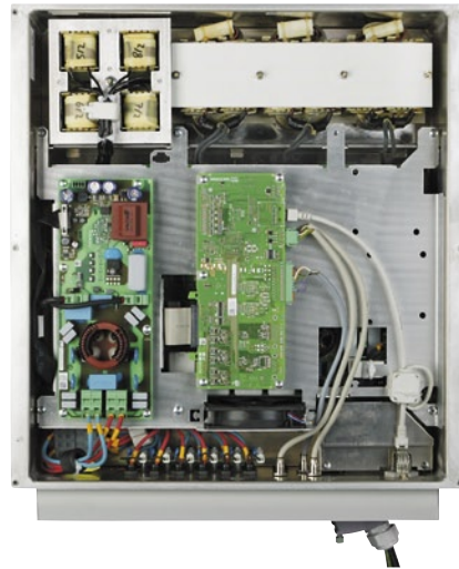
▲ Schon das Gehäuse verrät das wichtigste Merkmal und verkündet »Silicon Carbide Inside«. Das Innenleben ist gegenüber dem schon bekannten 020K kaum verändert. Auch die per Thermografie im mehrlagigen Aufbau sichtbaren und unbedenklichen Temperaturwerte sind sehr ähnlich.
