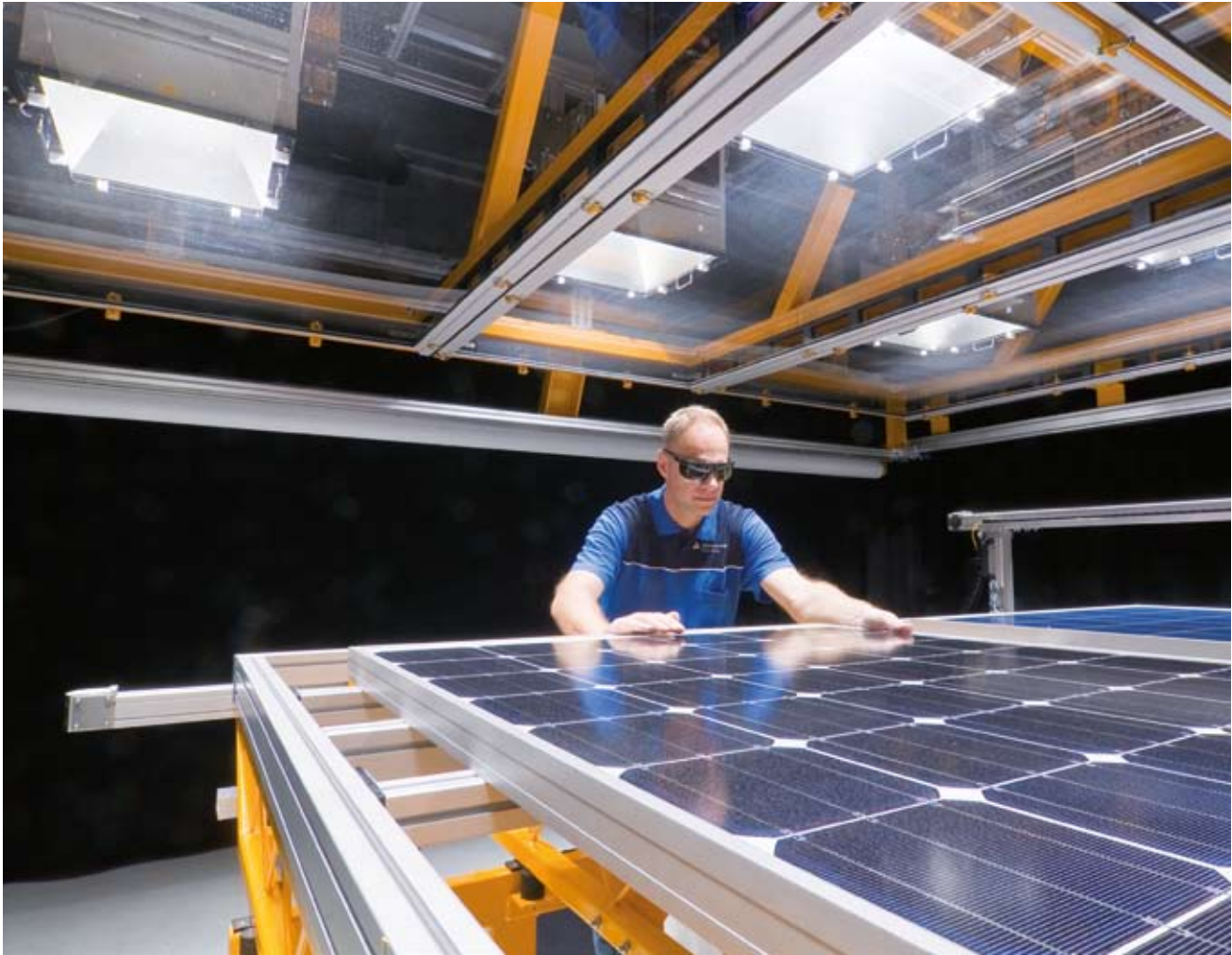
Im Sonnensimulator kann der TÜV Rheinland seine Messungen unter genau definierten Bedingungen durchführen.
