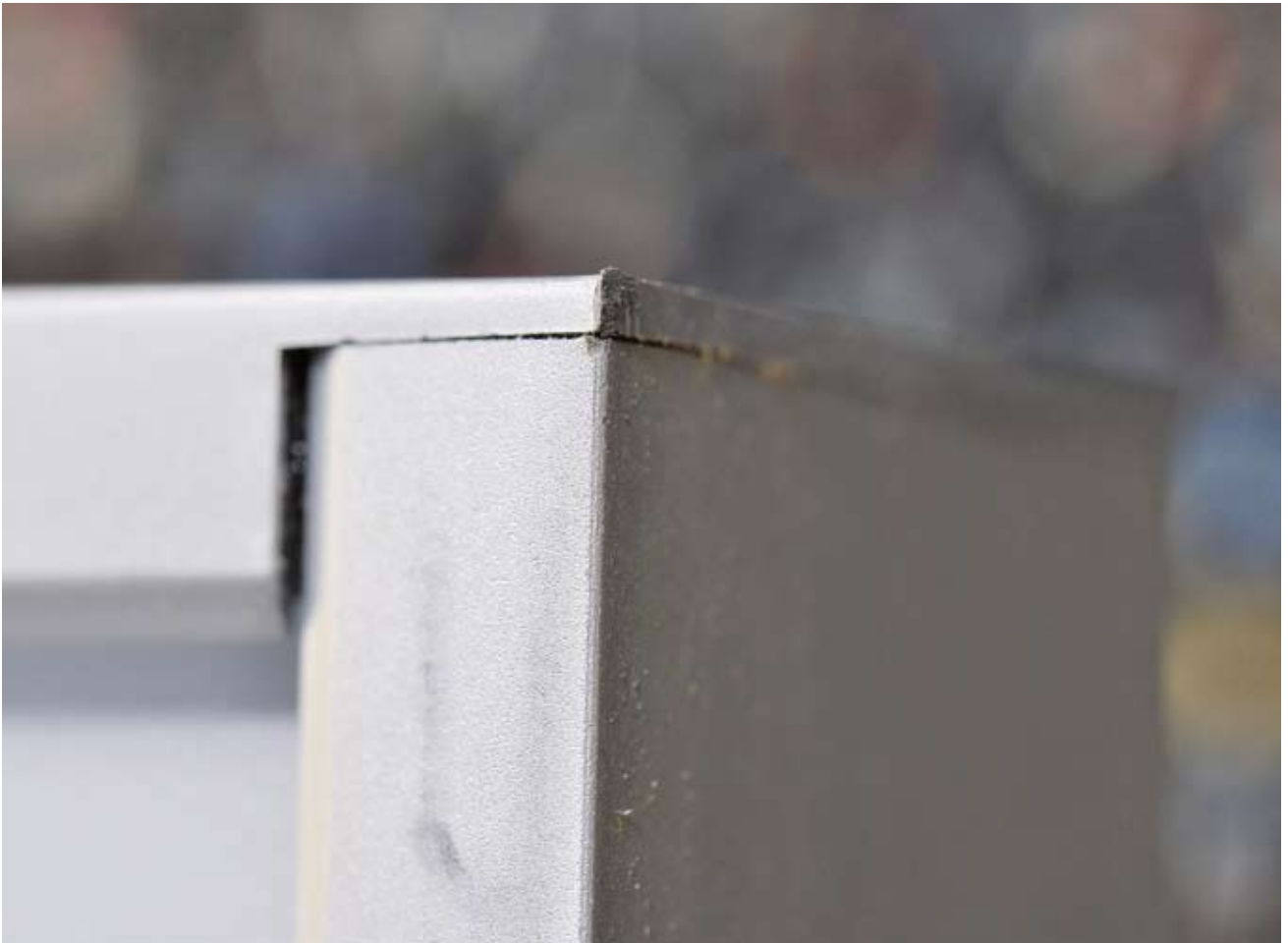
Scharfe Kanten und spitze Ecken können Installateure bei der Montage verletzen. Dafür gibt es Punktabzüge bei PV+Test.
