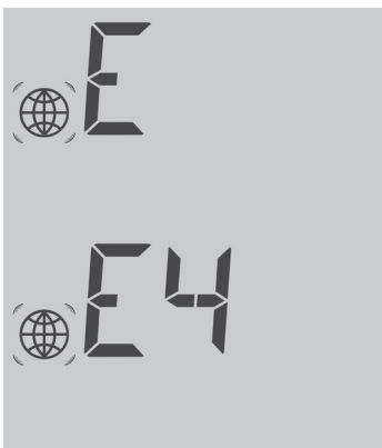
Abb.: Beispiel Blinkcodes für Internet - Fehler 4
