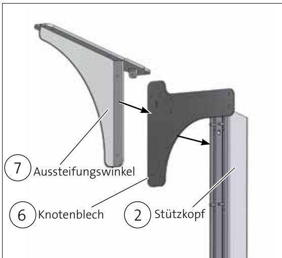
Abb. C 2-6 Einbau Winkel 105° und Knotenblech
