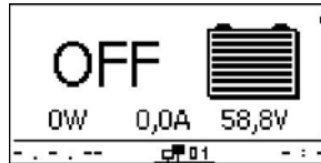
Abb. 7: Display nach dem Einschalten der externen Batteriesicherung
