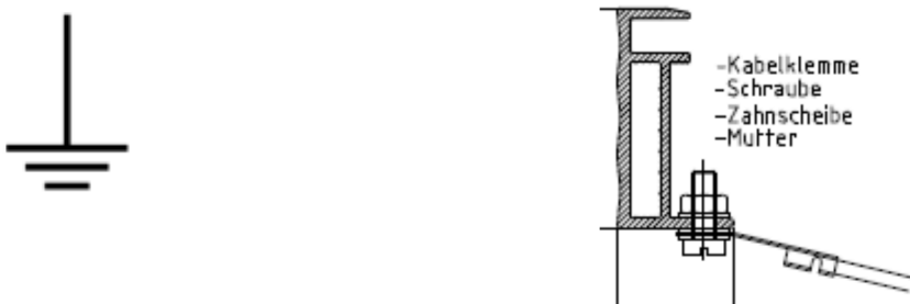
Abbildung 9: Potentialausgleich Symbol und Ausführung
