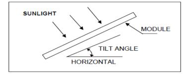
Figure1: PV module tilt angle
