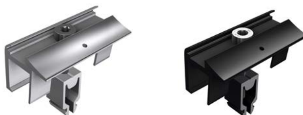
Endklemmen ohne Erdungspin für Rahmenhöhe 28 mm – 45 mm
