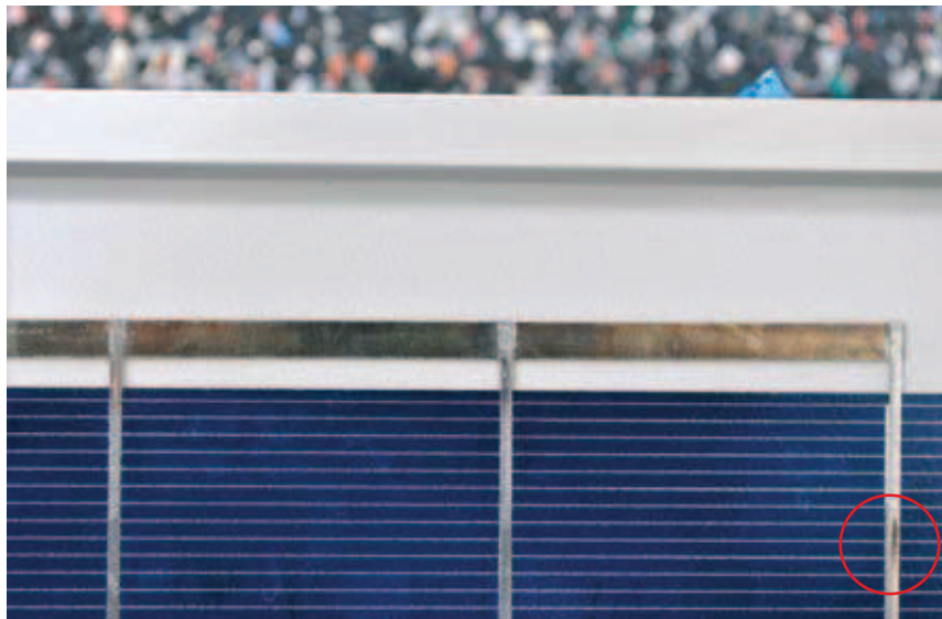
Nach dem Feuchte-Wärme-Test sind deutliche Verfärbungen auf den Stringverbindern zu sehen. Auch die Zellverbinder sind teilweise betroffen.
